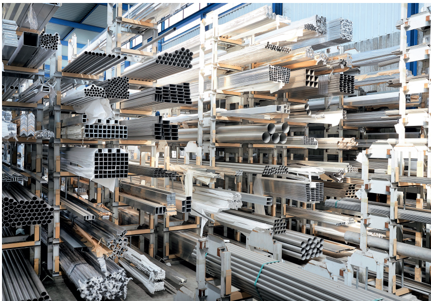
2 Rohre, Profile und Flachstahl verschiedener Abmessungen und Güten werden in einem Stapeljochelement des Typs 'Unibloc A' von Kasto deponiert © Kasto
